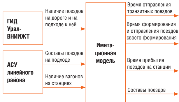
Рис. 2. Входная и выходная информация имитационных моделей
