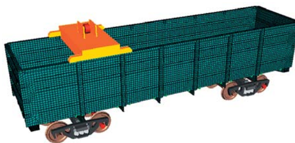
Рис. 2. Компьютерная модель механической системы «вибромашин — кузов полувагона — тележка»
