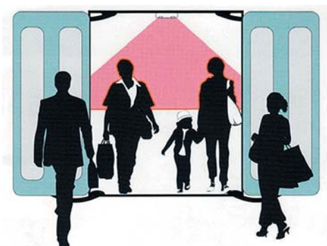
Рис. 5. Устройство модуля подсчета входа-выхода пассажиров в дверном проеме
